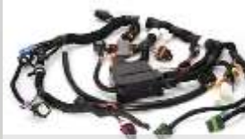
主電源及引擎線束
